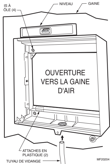
Fig. 5. Installation de l'humidificateur sur une gaine.
